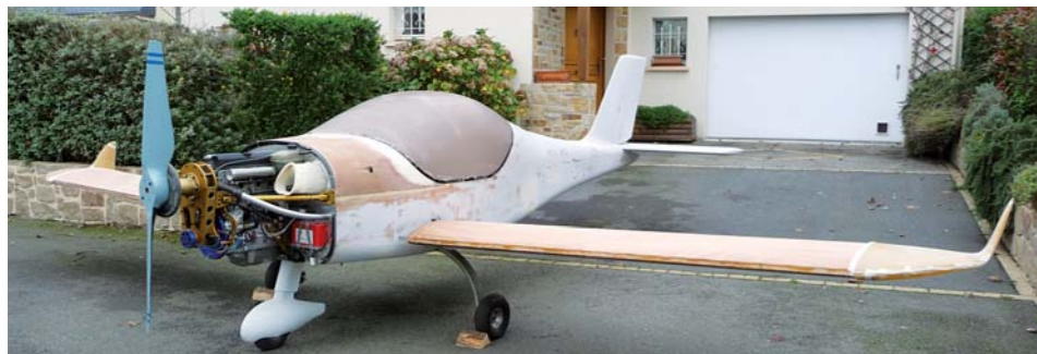
Jean-Jacques a construit son avion dans son garage. En haut, tronçonneuse à la main, il fabrique son hélice. Ci-dessus, l'avion après trois ans et demi de construction. A droite, le moteur diesel de Peugeot 106, 1 400 cm 3 avec réducteur fabriqué maison.
